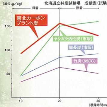
恒温恒湿の容器に試験体を入れ、初めに容器の中の条件を室温25℃—湿度57%に設定し10時間後に測定した。次に室温25℃—湿度90%に設定し10時間後に測定した。次に室温25℃—湿度57%に戻し10時間後に測定した。
