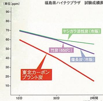
試験容器内(容積約20リットル)に炭化試験体5gを入れ、アンモニア及びホルムアルデヒドのガスを充満させて経過時間毎のガス濃度を検知管により測定した。
