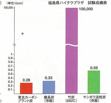
1.00ccの広口ビーカーに試験体を入れ、50kgの加重を加えて電極を差し込み、通電量測定した。粒子は0.5~3.0mmに統一して測定した。
